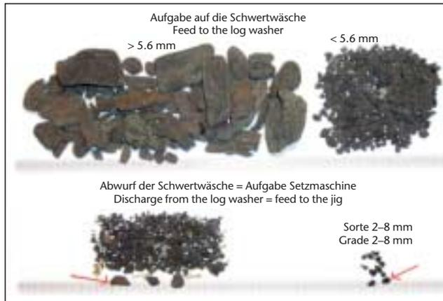
**Bild 3:** Korngrößen der Braunkohle im Prozess, vor der Optimierung
